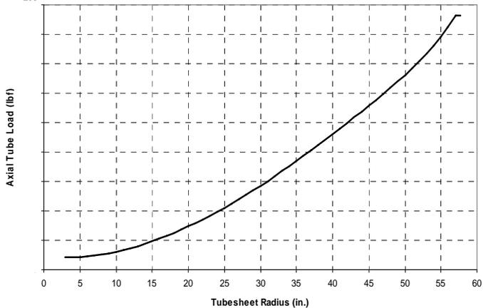
**FIGURE 3 TUBE LOAD VERSUS RADIUS**
