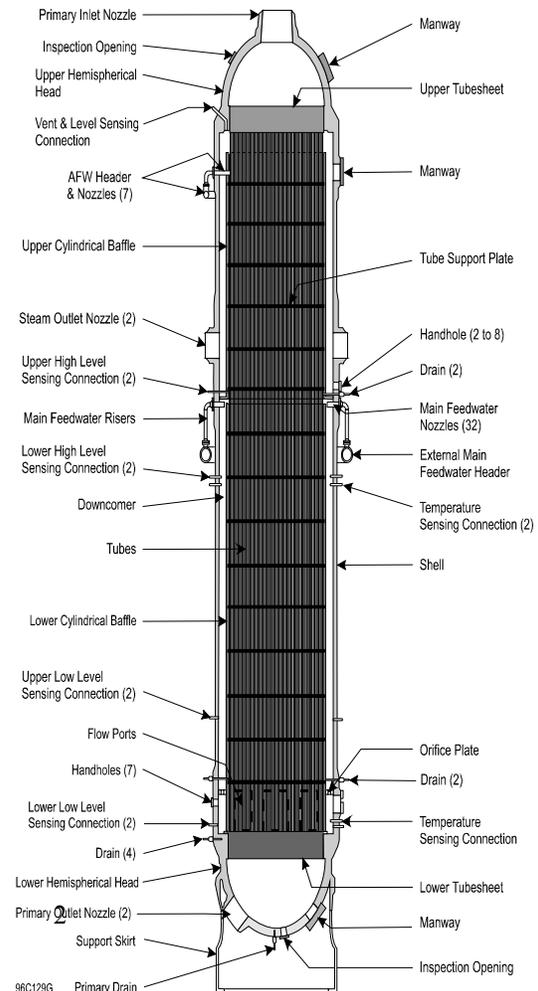
**FIGURE 1 OTSG GENERIC SCHEMATIC**
