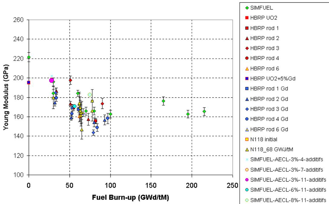
FIGURE 2 – YOUNG MODULUS VERSUS BURNUP FOR IRRADIATED SAMPLES
