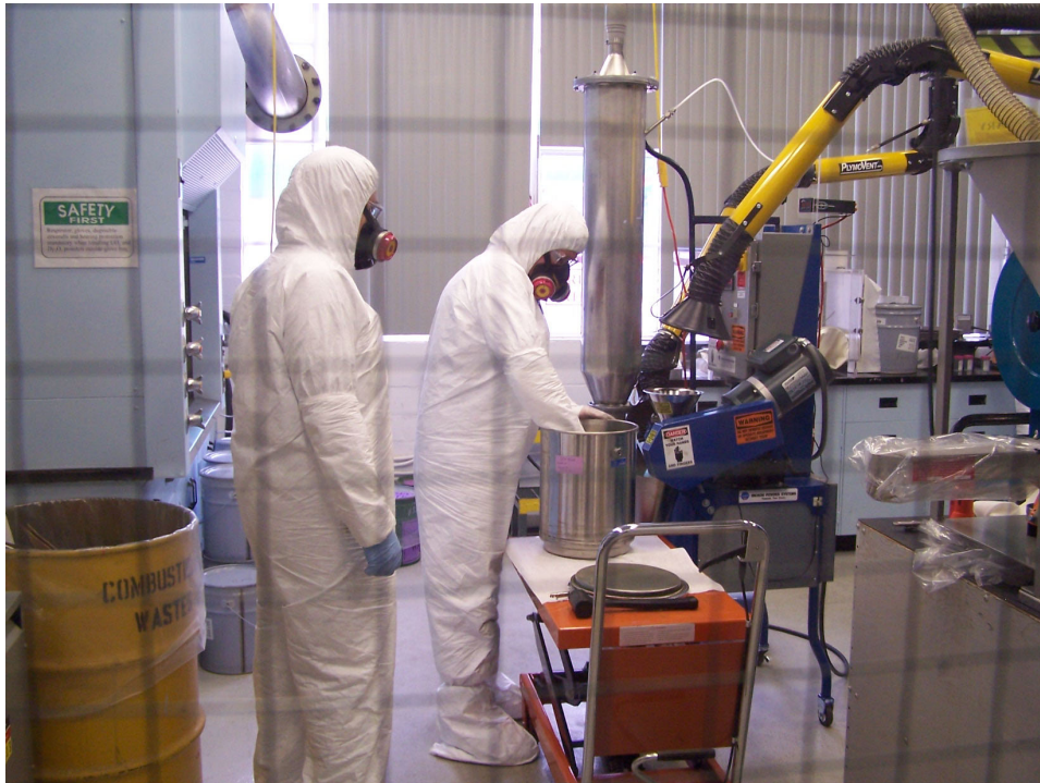
Figure 1. Blending SEU powder for DI
