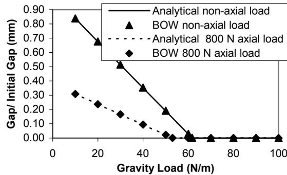
FIGURE 8 GAP VERSUS DISTRIBUTED LOAD
