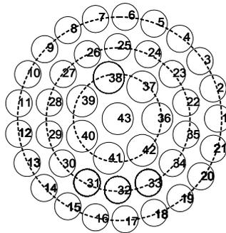
FIGURE 2 NUMBERING OF FUEL ELEMENTS IN A 43-ELEMENT FUEL BUNDLE
