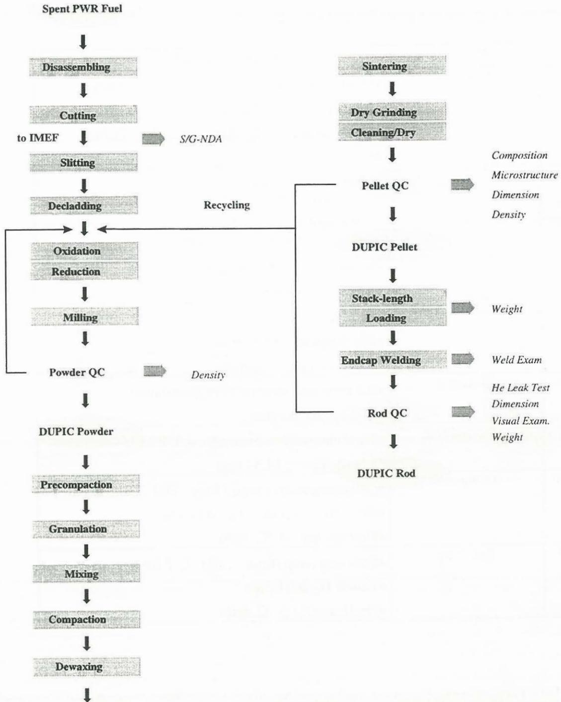
FIGURE 1. DUPIC FUEL FABRICATION PROCESS FLOW
