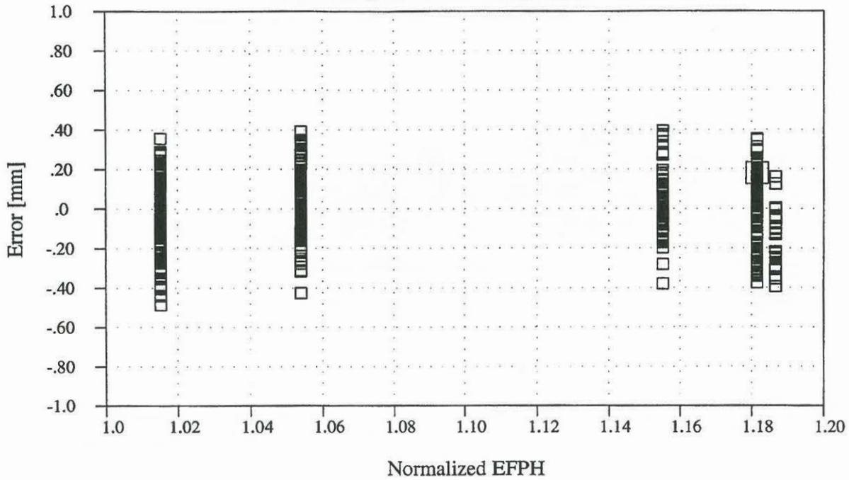
**FIGURE 12 : ERROR IN PRESSURE TUBE DIAMETER AS FUNCTION OF TEMPERATRURE
