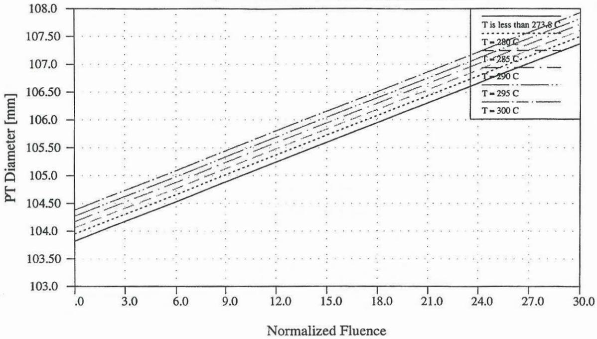
**FIGURE 16 : PRESSURE TUBE DIAMETRAL STRAIN AS FUNCTION OF FLUENCE AND TEMPERATURE
