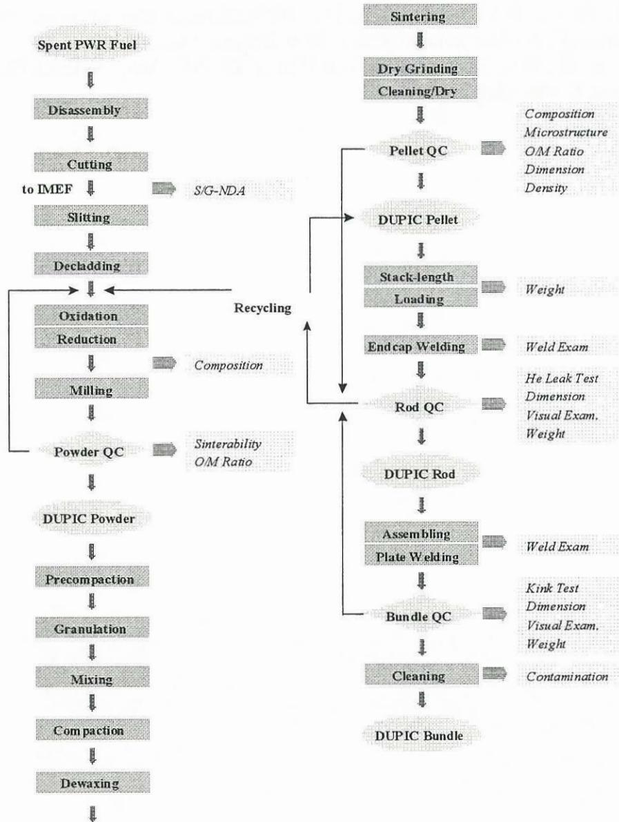
FIGURE 1: DUPIC FUEL FABRICATION FLOWSHEET
