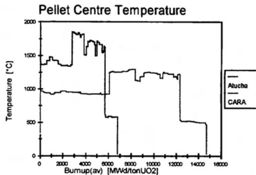
FIGURE 13: LOCAL TEMPERATURE IN THE SEVENTH SEGMENTS OF A FUEL ROD FOR ATUCHA I CARA FUEL.
