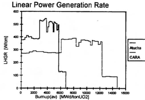
FIGURE 12: LOCAL POWER HISTORY FOR THE SEVENTH SEGMENTS OF A FUEL ROD OF THE ATUCHA I NPP AND CARA FUEL.
