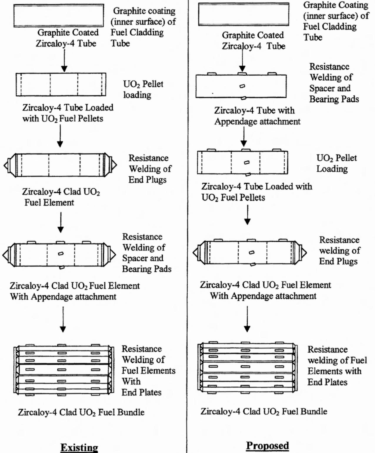
**FIG.6 : PICTORIAL SEQUENCE OF ASSEMBLY OPERATIONS FOR PHWR FUEL BUNDLE PRODUCTION**
