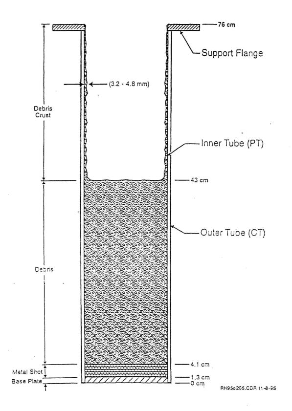
FIGURE 4 POST-TEST OBSERVATION OF DEBRIS CONFIGURATION
