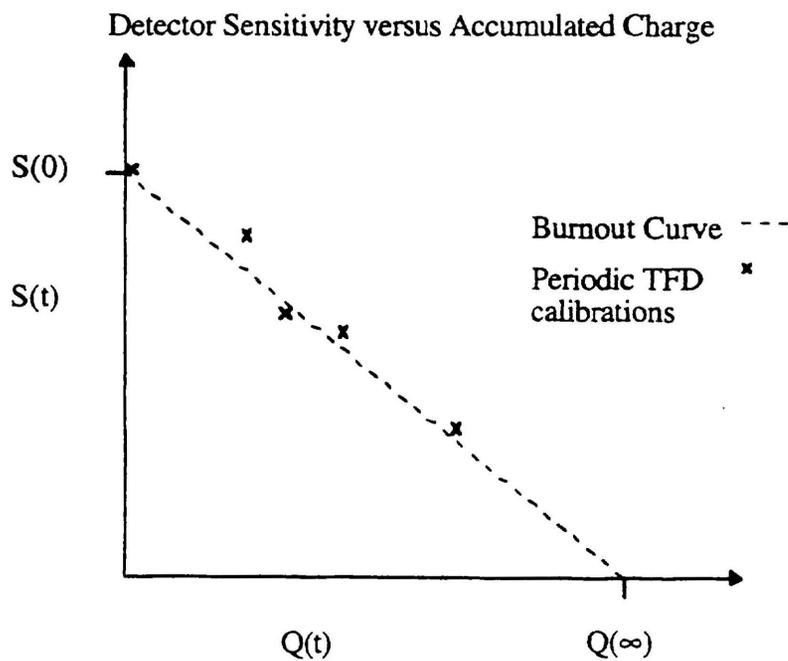
FIGURE A.1 TYPICAL VANADIUM BURNOUT CURVE
