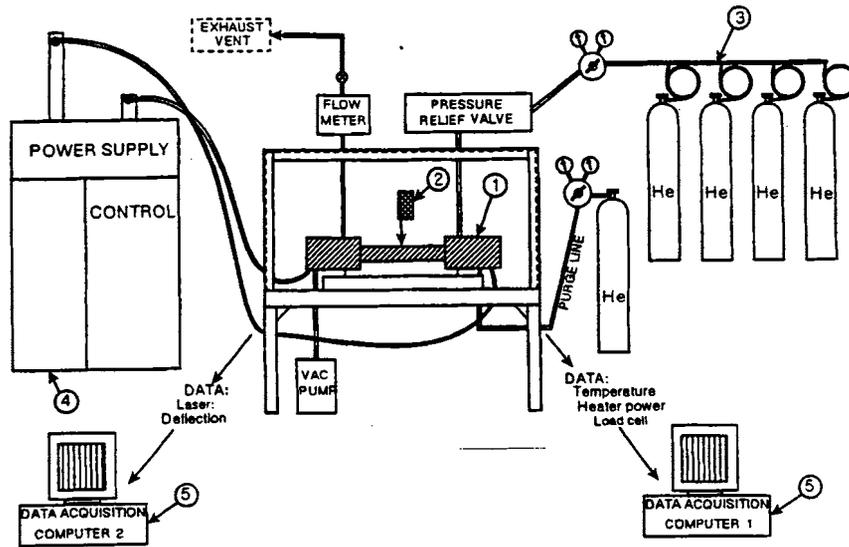
FIGURE 1: COMPONENTS OF THE BOW TEST FACILITY: 1) BOW TEST CHAMBER, 2) LASER HEAD, 3) GAS SUPPLY SYSTEM, 4) POWER SUPPLY, 5) DATA ACQUISITION SYSTEM
