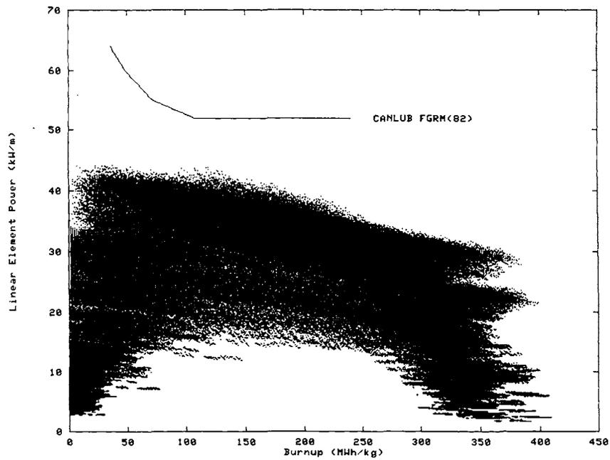
FIGURE 2. BUNDLE-MAXIMUM LINEAR-ELEMENT POWERS vs. BURNUP FOR RU CANFLEX FUEL USING A 2-BUNDLE SHIFT
