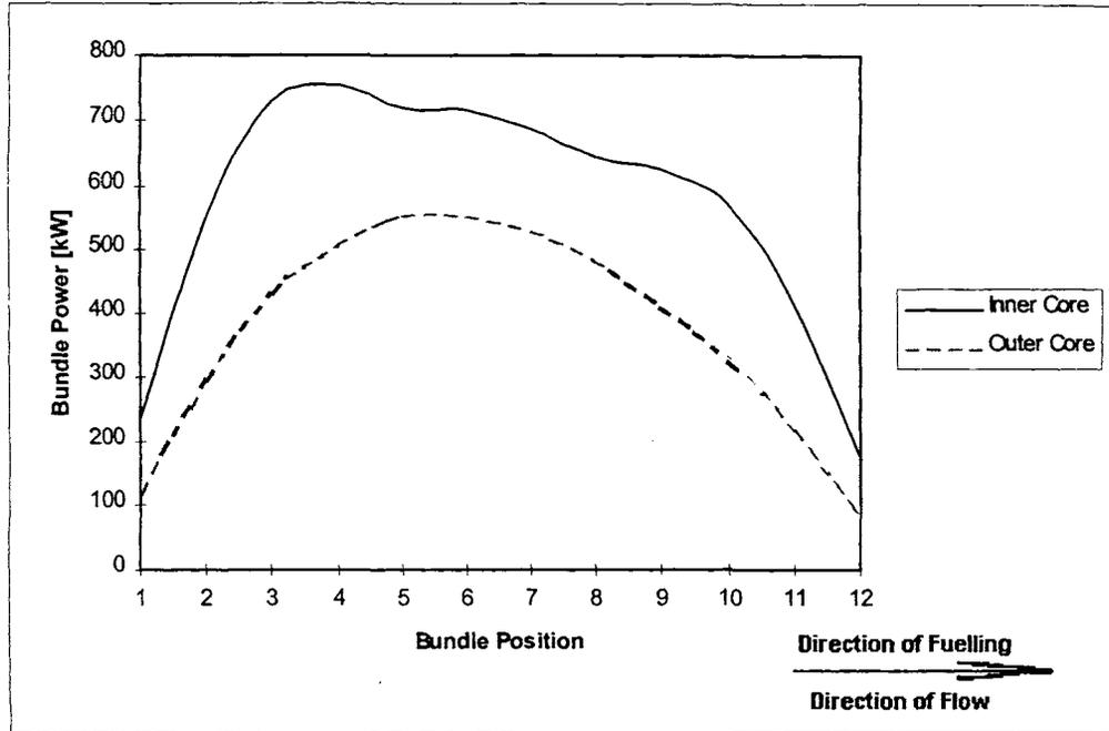
FIGURE 3. TYPICAL AXIAL POWER DISTRIBUTION (time-average data)
