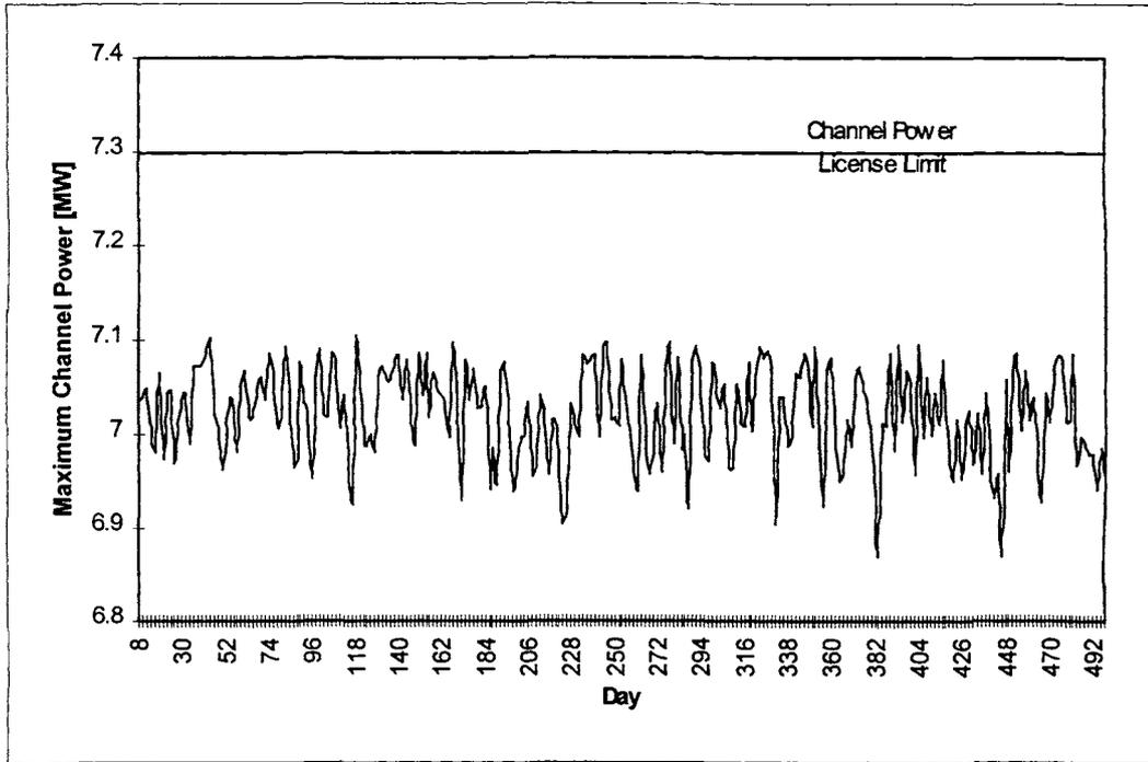
FIGURE 5. MAXIMUM CHANNEL POWERS OVER THE 500 FPD CORE FOLLOW
