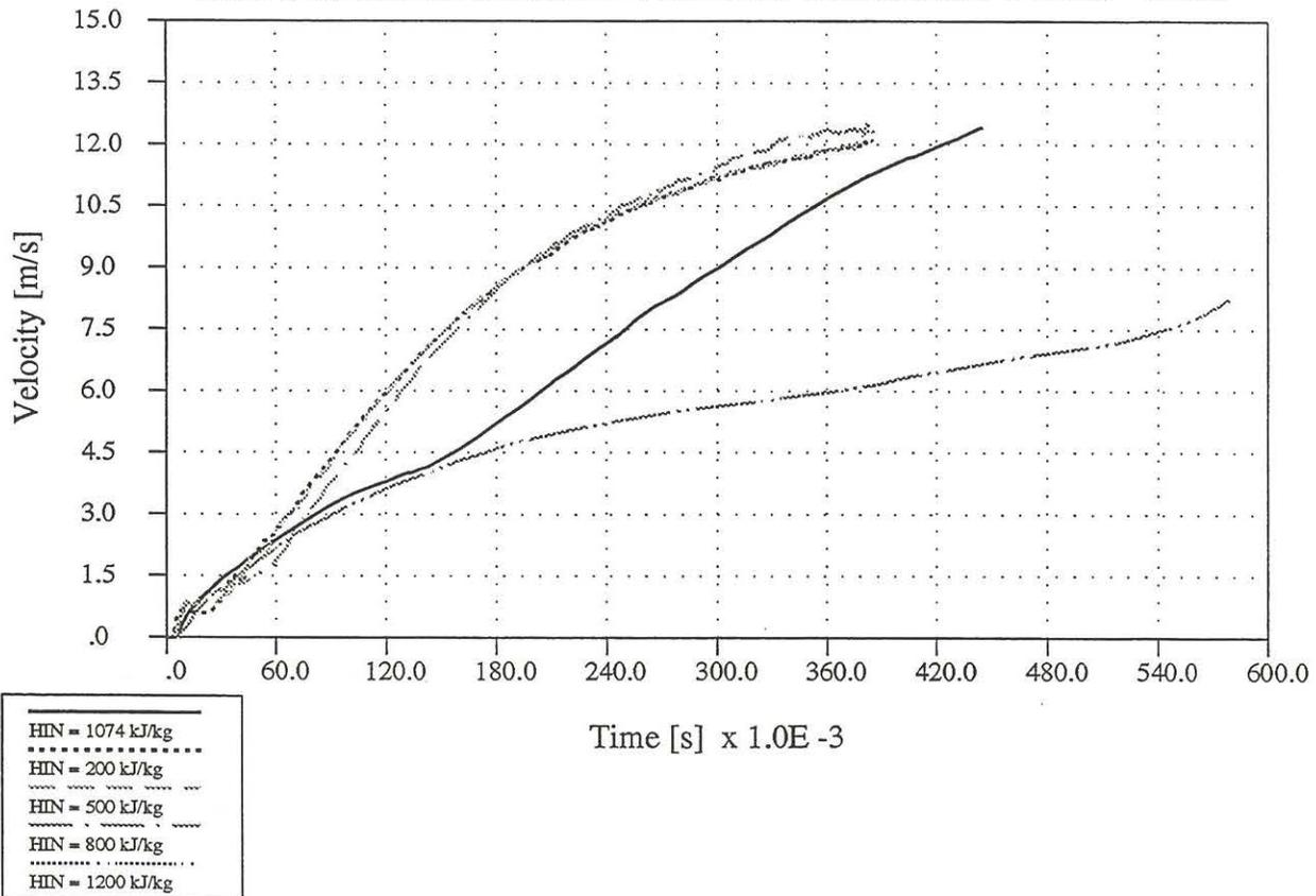
**FIGURE 9: BUNDLE VELOCITY VS TIME (NO BUNDLE MISSING)
