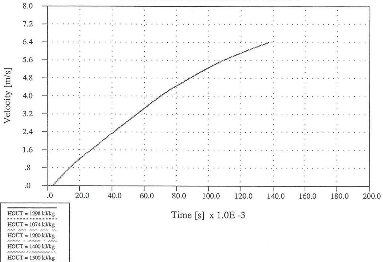
**FIGURE 10: BUNDLE VELOCITY VS TIME (5 BUNDLES MISSING)
