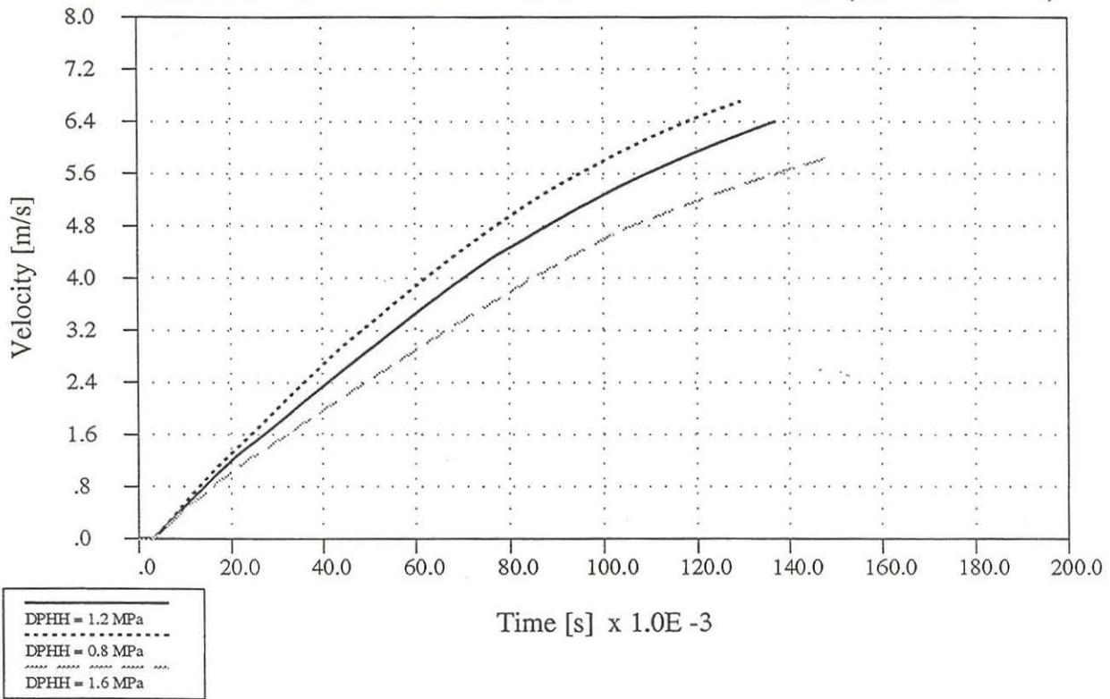
**FIGURE 16: BUNDLE VELOCITY VS TIME (5 BUNDLE MISSING)
