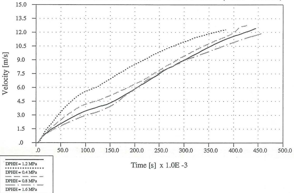
**FIGURE 15: BUNDLE VELOCITY VS TIME (NO BUNDLE MISSING)
