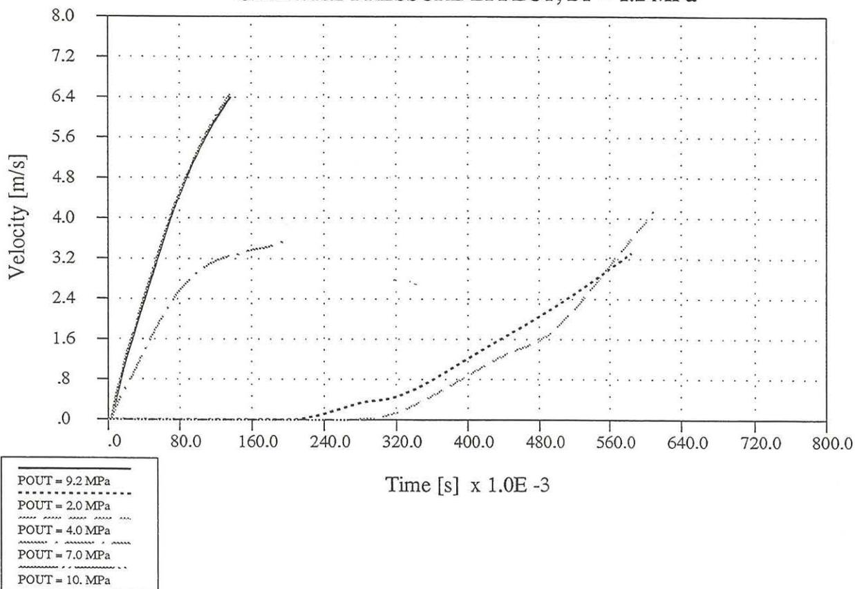
**FIGURE 12: BUNDLE VELOCITY VS TIME (5 BUNDLE MISSING)**
