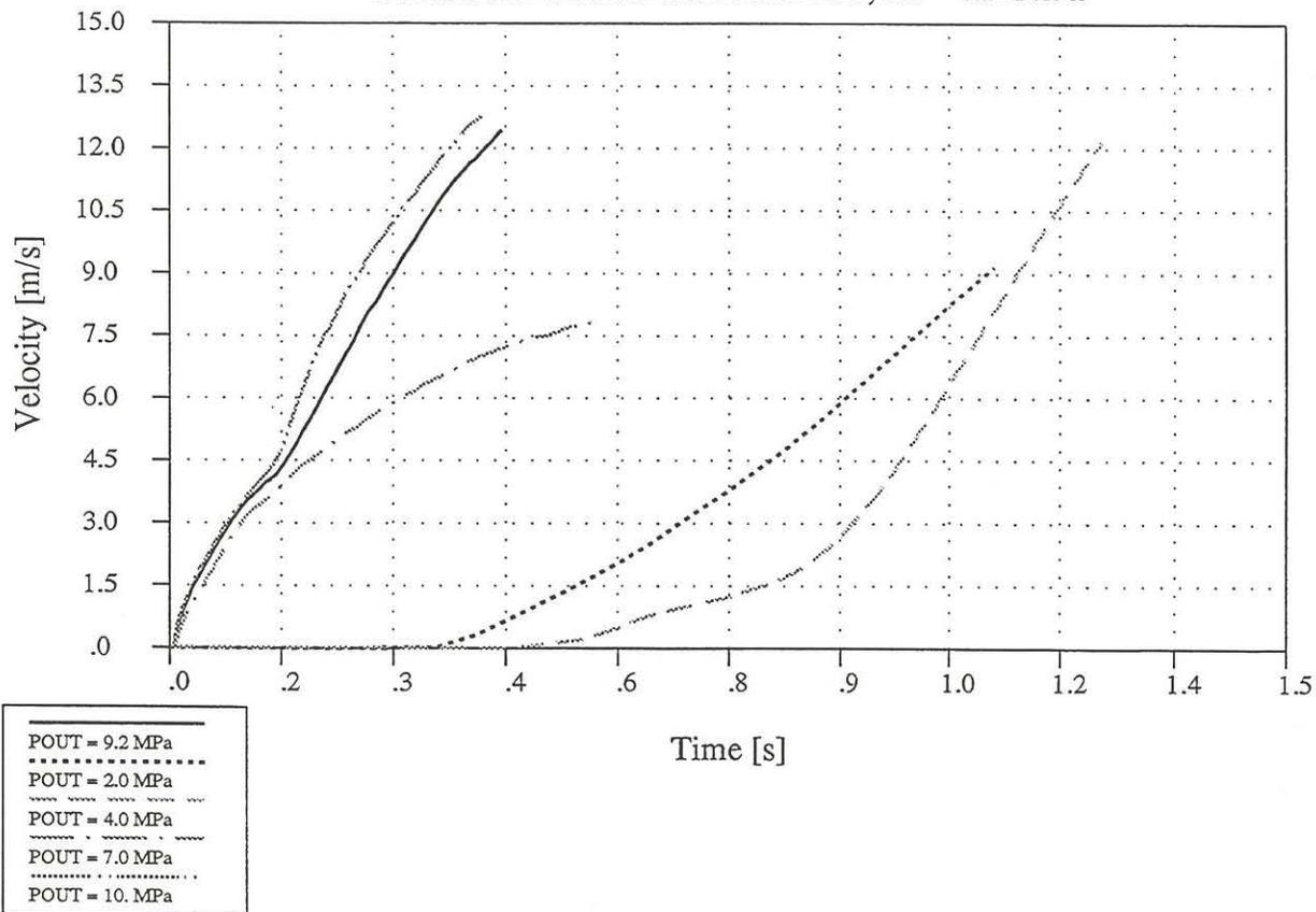
**FIGURE 13: BUNDLE VELOCITY VS TIME (NO BUNDLE MISSING)
