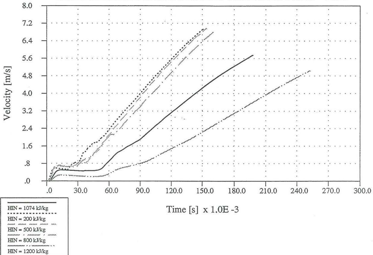
**FIGURE 6: BUNDLE VELOCITY VS TIME (5 BUNDLE MISSING)
